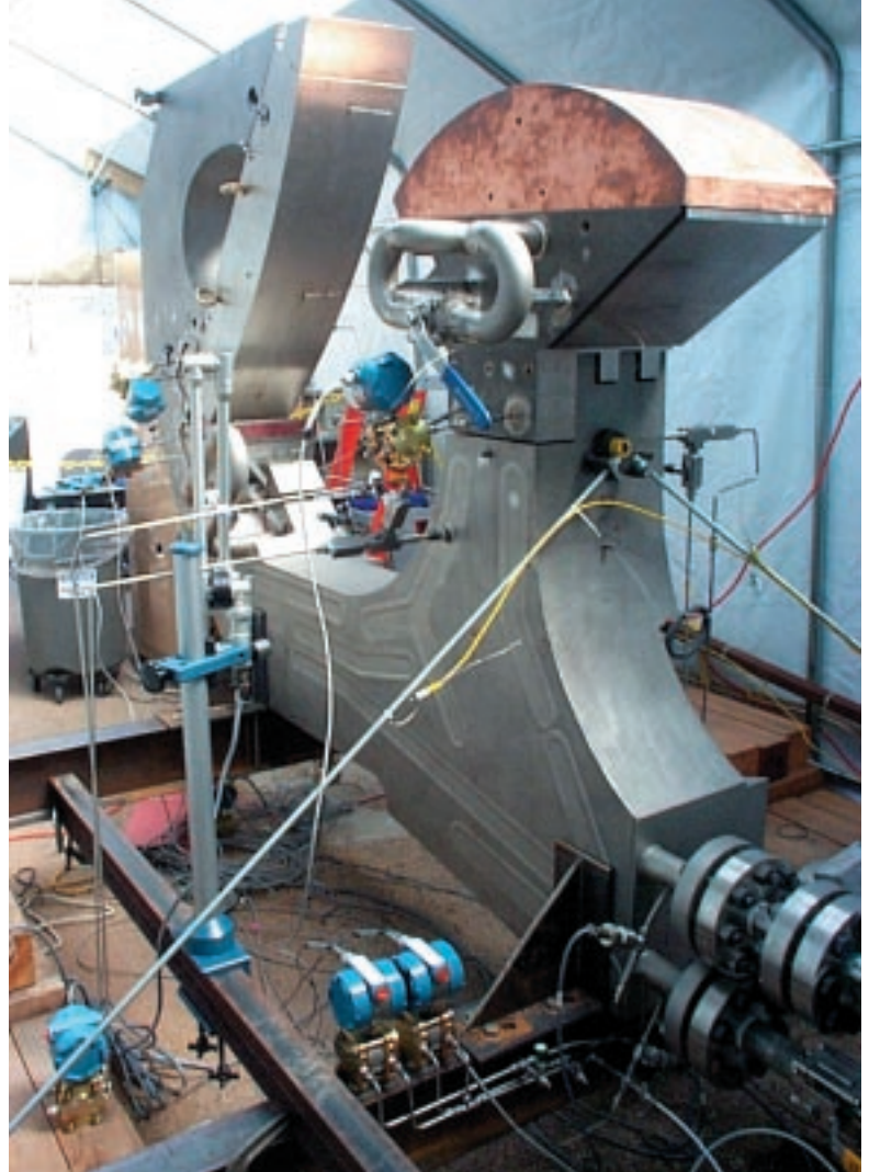
Кассета дивертора на рисунке и в цехе
